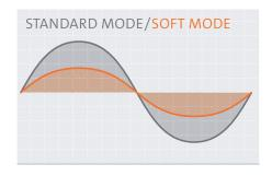
Si suggerisce di utilizzare gli inserti impostando il programma scaling/perio potenza 3 attivando la funzione soft mode. Il SOFT MODE riduce l'ampiezza delle oscillazioni, permettendo un movimento dell'inserto delicato, ma efficace. I pazienti più sensibili ne trarranno grande beneficio e saranno più propensi ad affrontare i trattamenti di igiene.
