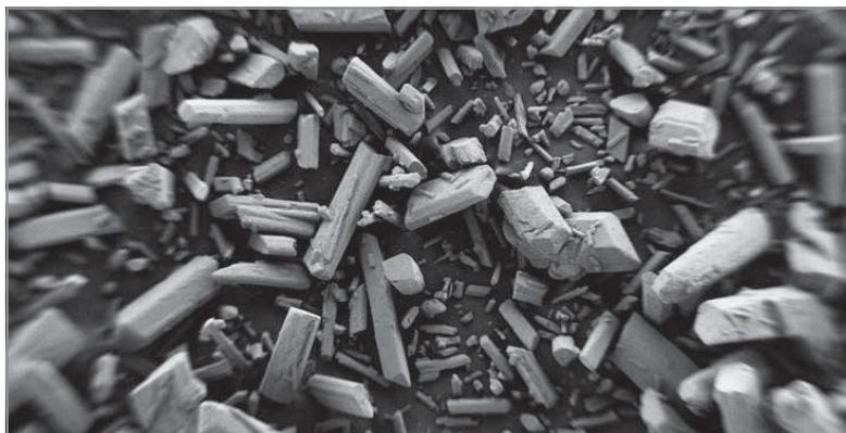
*Cristalli di bicarbonato con ingrandimento 100x (immagine fornita per gentile concessione da 3M Espe)*
