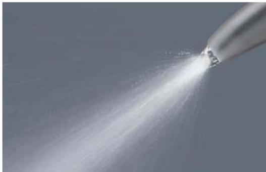
Inoltre, la geometria ed il design dell'ugello del terminale pulitore sono importanti caratteristiche che possono influenzare le proprietà abrasive delle polveri utilizzate. Piccole alterazioni nelle dimensioni dell'ugello, come il diametro dell'apertura o la lunghezza del tubo o la curvatura, possono infatti indurre cambiamenti significativi sull'efficacia dello strumento (Momber A, 2008).
