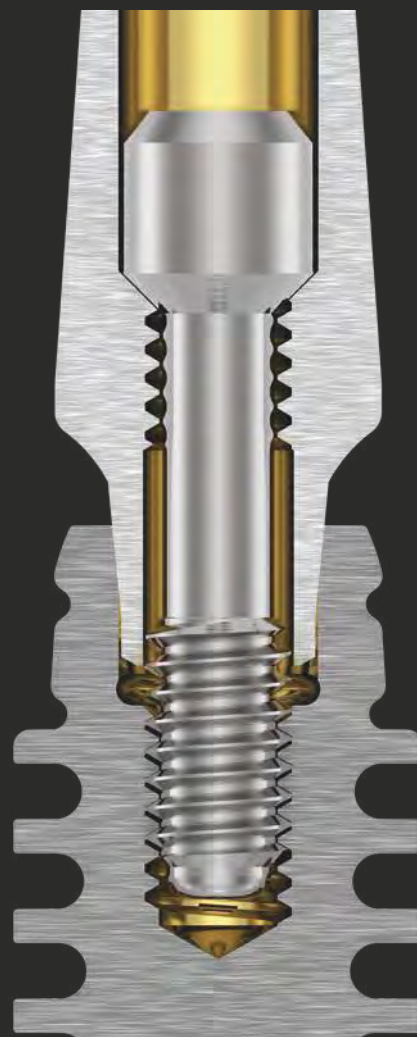
Sezione della connessione tra impianto REX PiezoImplant BL 2.9 e vite di ritenzione
